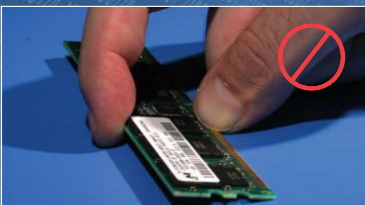
モジュールを持ち上げる時、ゴールドコネクタを押さえないでください。
